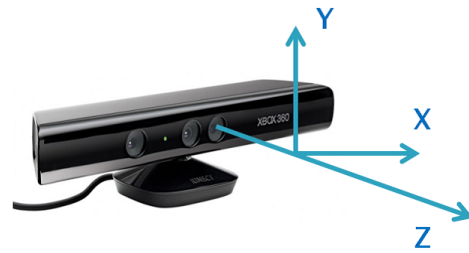
図 3 Kinect コントローラとその座標系
