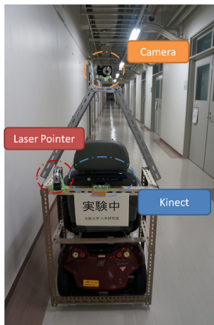
図 7 Kinect とレーザーポインタ、カメラの設置位置
